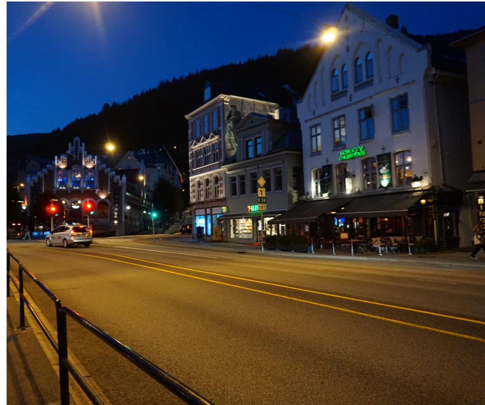
Dårlig fargegjengivelse i gatebelysning
